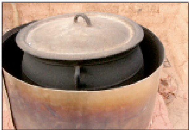
Une marmite noire est le signe d'une mauvaise combustion, due au combustible ou à une mauvaise construction.
